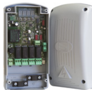
Modulo RBE4230 art. 806RV-0020 (Alimentazione 110/230 VAC - 4 Relè 5A - Gestione fino a 4 tastiere)
